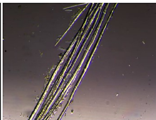
Obr. 2. Vlákno z plátna v prechádzajúcom svetle (svetlé pole)
