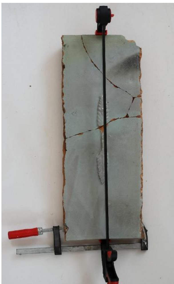
48-49. Lepenie kachlíc. Kachlice boli lepené epoxidovým lepidlom. Jednotlivé spoje museli byť zafixované proti pohybu. Na fixovanie boli použité stolárske svorky.
