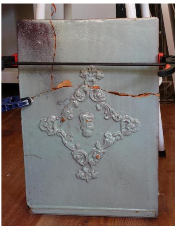
44-45. Lepenie kachlíc. Kachlice boli lepené epoxidovým lepidlom. Jednotlivé spoje museli byť zafixované proti pohybu. Na fixovanie boli použité stolárske svorky.
