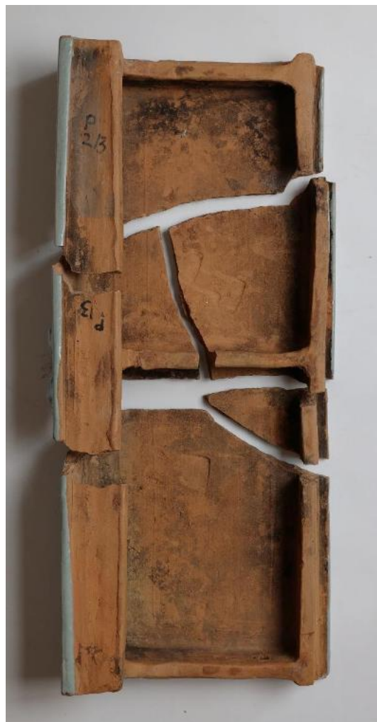
21-22. Rohová kachlica z ohniskovej časti po očistení od hlíny a sadzí. Kachlica je zlomená na viacero častí.
