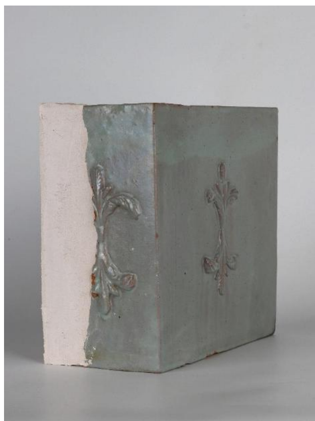
84-85. Dopĺňanie hmoty na zadnej kachlici s prekladovej časti pece, nad stĺpmi.
