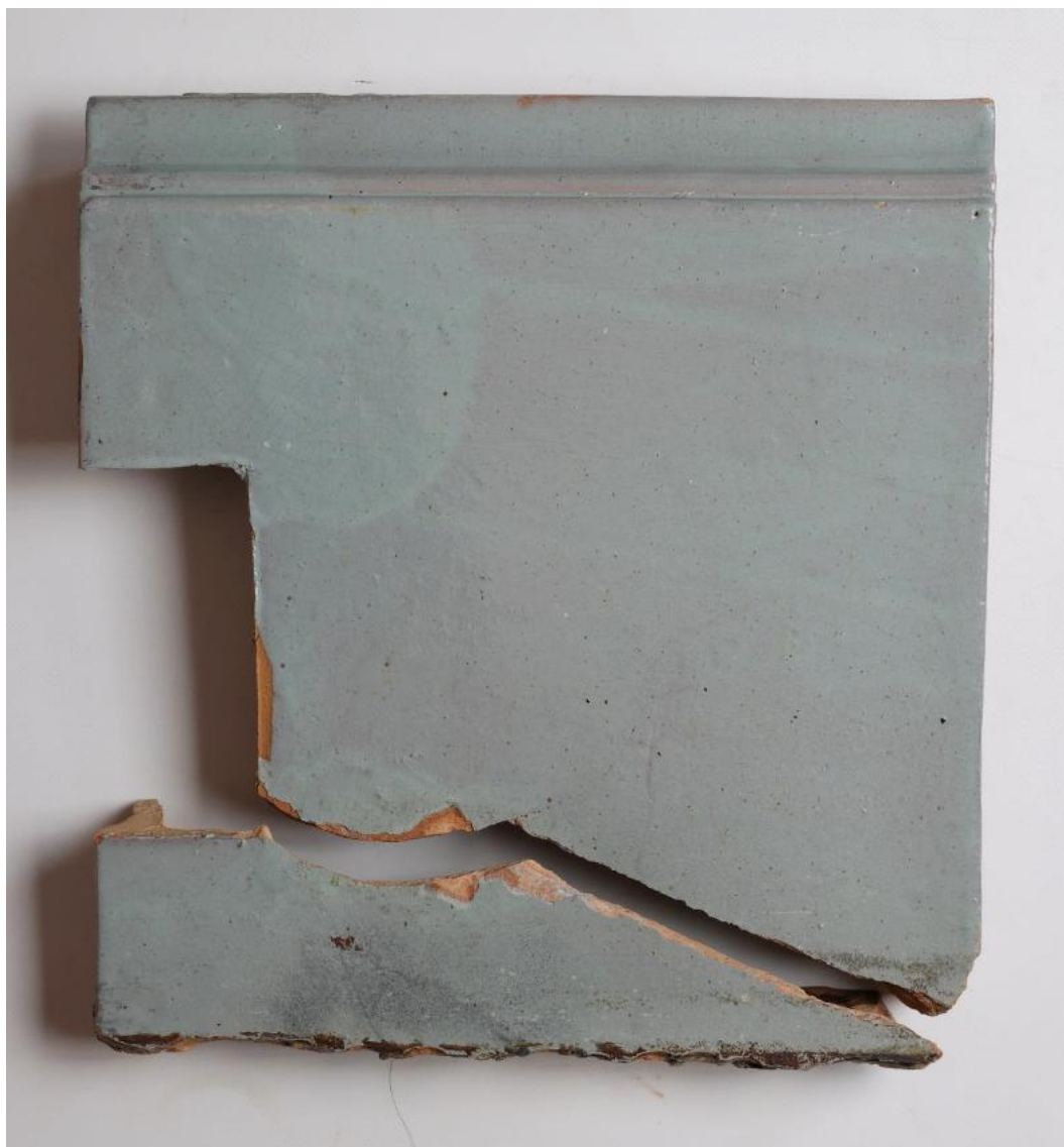
4. Kachlica zo soklovej časti pece. Kachlica po umytí a odmastení. Boli odstránené zvyšky kachliarskej hliny a sadzí. Kachlica bola zo zadnej strany umytá čistiacim prostriedkom.
