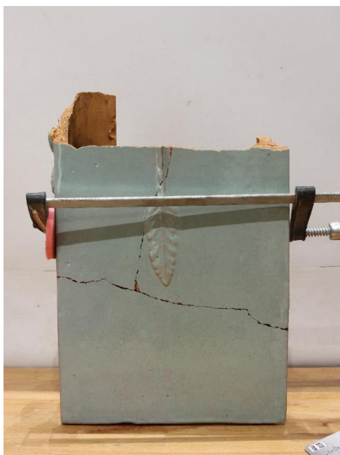
40-41. Lepenie kachlíc. Kachlice boli lepené epoxidovým lepidlom. Jednotlivé spoje museli byť zafixované proti pohybu. Na fixovanie boli použité stolárske svorky.
