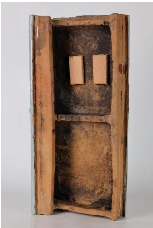
103-106. Lepené kachlice boli v miestach zlomoch zo zadnej strany spevnené malými keramickými doštičkami. Doštičky boli prilepené lepidlom Dispercoll D2.
