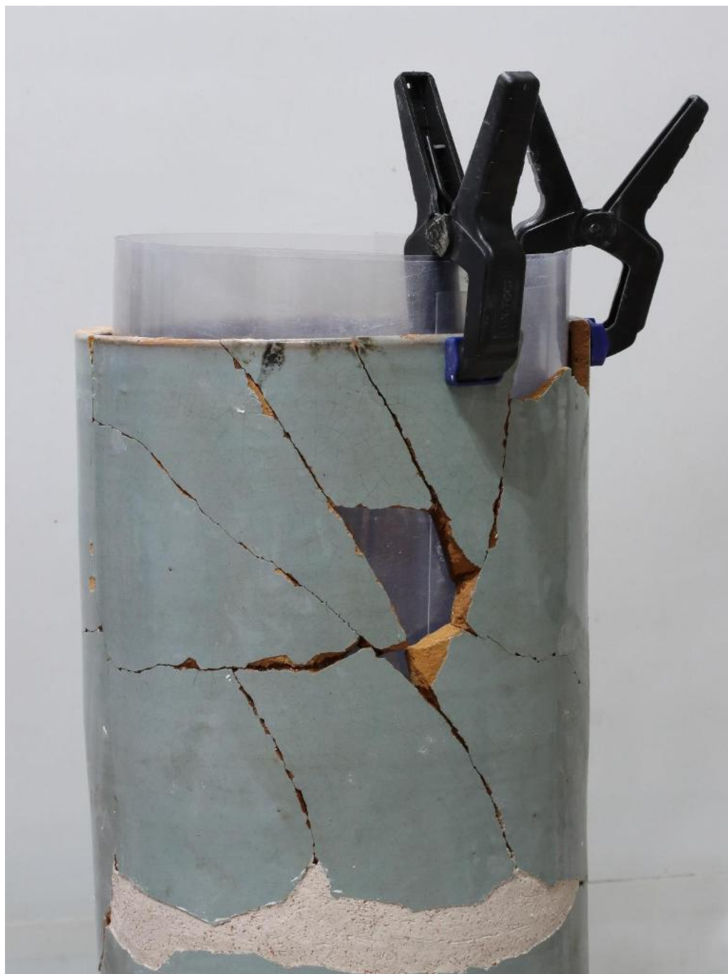
82. Príprava na doplnenie chýbajúcej hmoty na stĺpovej kachlici.
