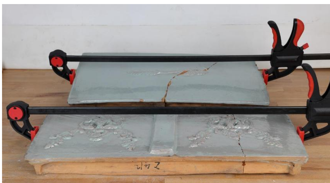
36-37. Lepenie kachlíc. Kachlice boli lepené epoxidovým lepidlom. Jednotlivé spoje museli byť zafixované proti pohybu. Na fixovanie boli použité stolárske svorky.
