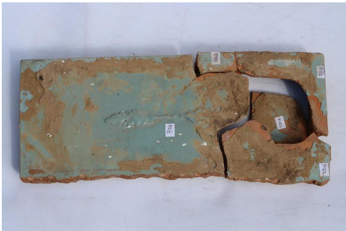
20. Polámaná kachlica – na lomoch dobre vidieť olupujúcu sa glazúru
