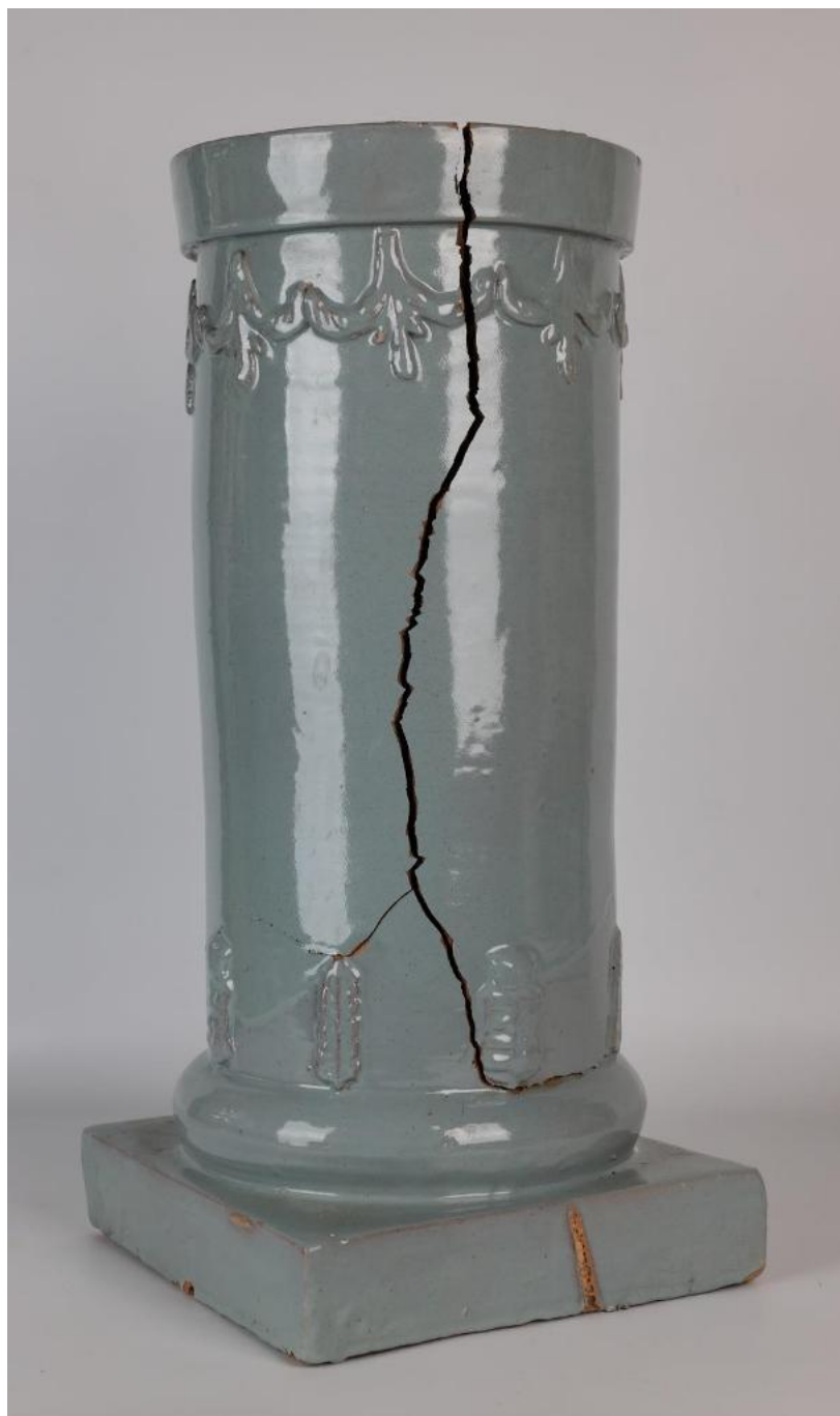
27. Spodná časť stĺpu z pravej zadnej strany pece. Cez stĺp pôvodne prechádzal ťah pece. Vplyvom pnutia pri vysokých teplotách praskol.
