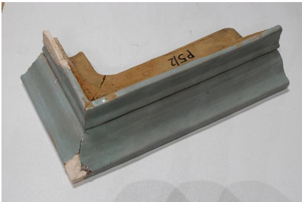
90-92. Stredne veľké úbytky boli dopĺňané postupne tmelom vytvorený z lepidla Dispercoll D 2 a keramického prachu so šamotovej hlíny.
