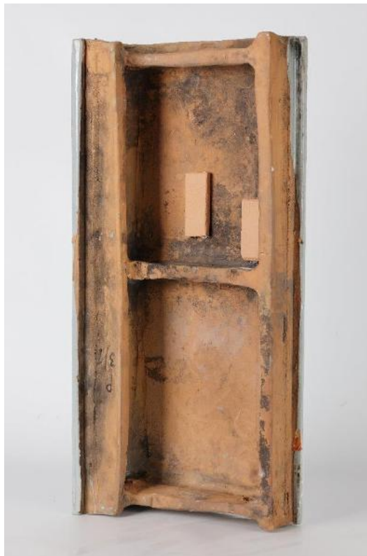
103-106. Lepené kachlice boli v miestach zlomoch zo zadnej strany spevnené malými keramickými doštičkami. Doštičky boli prilepené lepidlom Dispercoll D2.
