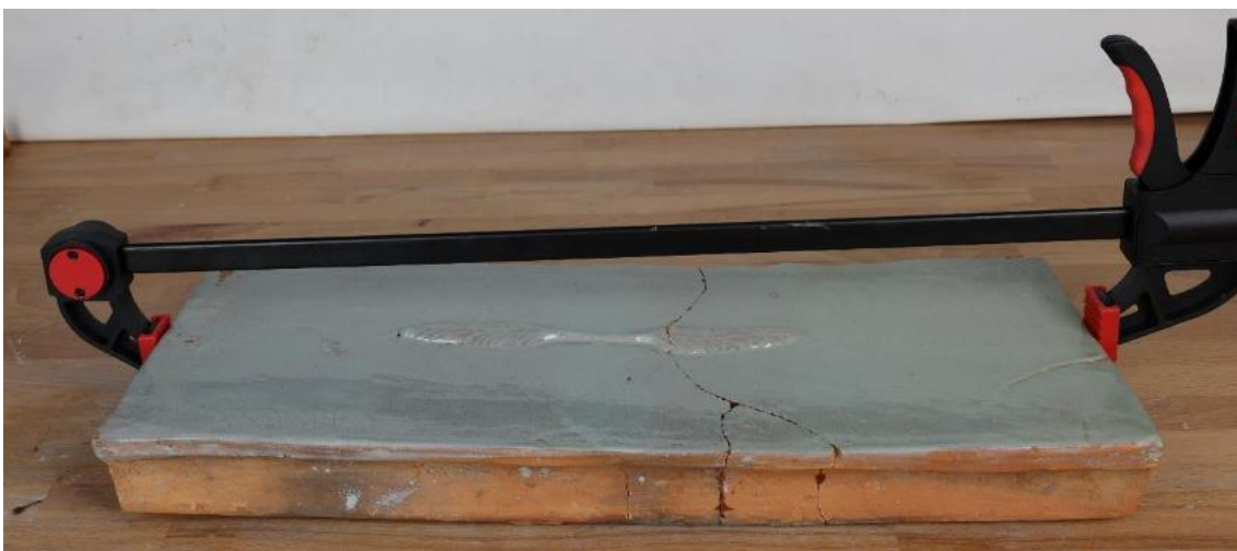
38-39. Lepenie kachlíc. Kachlice boli lepené epoxidovým lepidlom. Jednotlivé spoje museli byť zafixované proti pohybu. Na fixovanie boli použité stolárske svorky.
