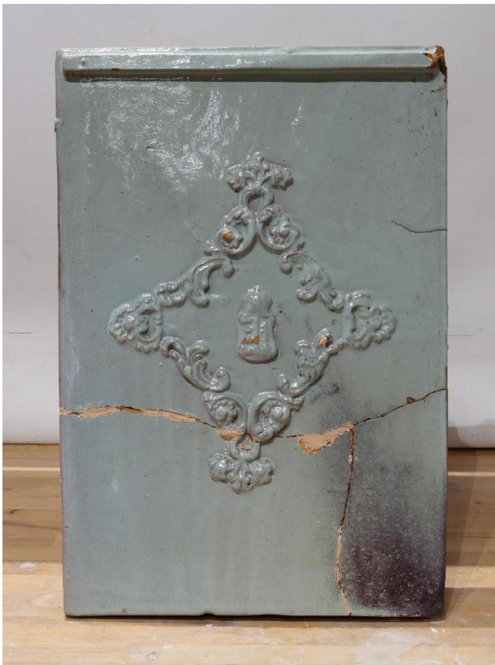
94. Stredne veľké úbytky boli dopĺňané postupne tmelom vytvorený z lepidla Dispercoll D 2 a keramického prachu so šamotovej hlíny.
